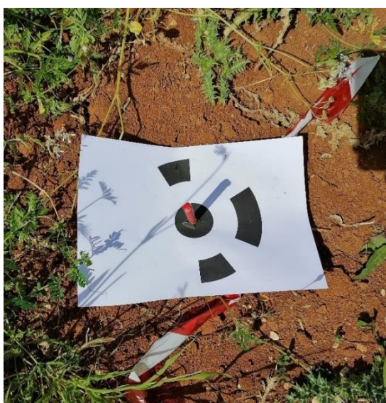
Εικόνα 16. Σήμανση φωτοσταθερών σημείων.
